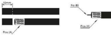
3. Corte a segunda capa até o fio rígido, tomando cuidado para não cortar o fio (B), remova a capa descobrindo o cabo rígido.
