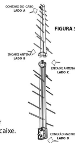
Antes de colocar a antena no Mastro, verifique se o encaixe está correto e firme.
